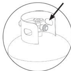
Входное отверстие баллона
